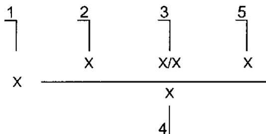
1 — вид проката (ОК); 2 — наличие покрытия на лицевой и обратной сторонах (3.2); 3 — обозначение материала покровного слоя лицевой и обратной сторон (4.1.3); 4 — размер и условное обозначение материала исходной заготовки (4.1.1); 5 — обозначение настоящего стандарта
